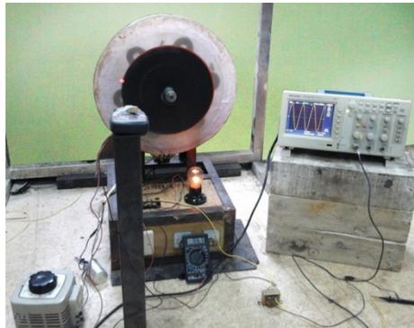
Gambar 10. Konstruksi Generator listrik MPFA yang dibuat.
