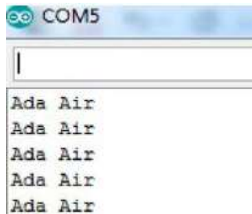
Gambar 14. Uji Coba Sensor Air Setelah Menyentuh Media Air
