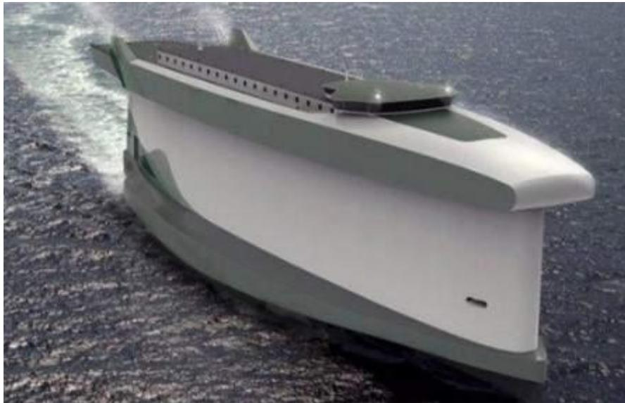
Kapal Vindskip yang diterjemahkan menjadi “windship” adalah sebuah alat transportasi laut modern yang menggunakan tenaga angin dan gas sebagai bahan bakarnya. Adalah Terje Lade seorang insinyur asal Norwegia yang merancang sebuah kapal cargo yang bergantung pada bahan bakar alternative untuk sumber tenaganya sehingga akan menurunkan emisi, konsumsi bahan bakar, dan biaya bunker, dalam upaya untuk membuat kapal lebih eko-efisien.
