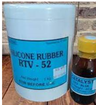
Gb. 3. Bahan Silikon Rubber dan katalis untuk membuat cetakan
