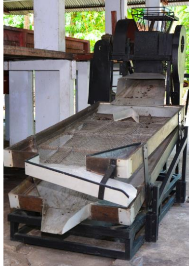
Gambar 2. Mesin Pemecah Biji Kakao
