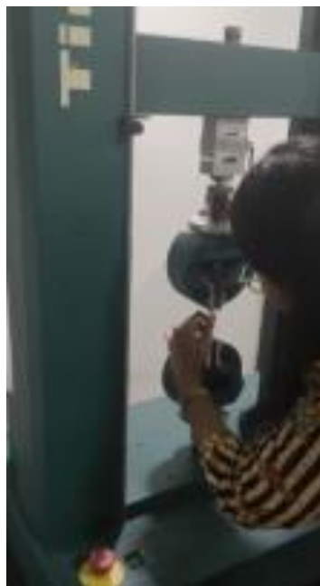
Gambar 6. Proses Pemasangan Benda pada Mesin Uji Tarik ( Ultimate Tensile Strength )
