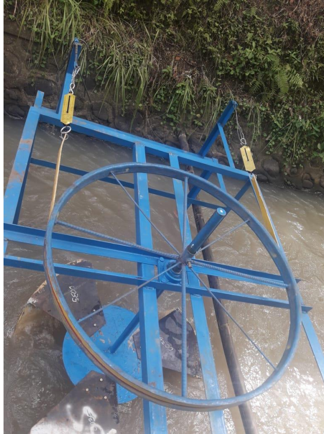
Gambar 4. Pengujian turbin helik untuk memanfaatkan energi aliran air di saluran irigasi Way Tebu
