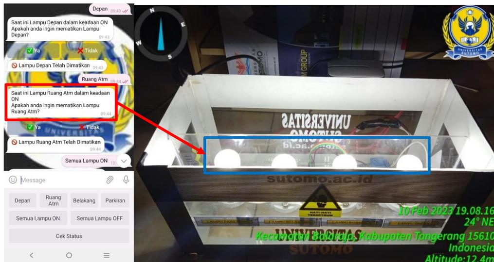
Gambar 10. Notifikasi Telegram Bot. dan Hasil Otomatisasi Nyala Lampu LED
