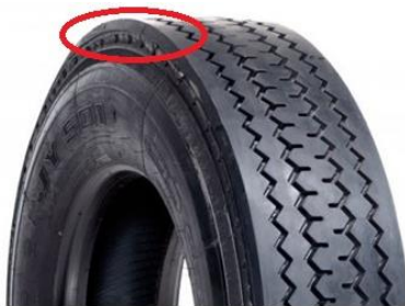
Gambar 1. Ban truk vulkanisir tanpa lapisan karet di area shoulder
