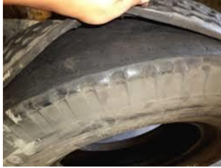
Gambar 3. Terlepasnya lapisan tapak dari sisi shoulder.
