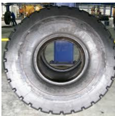
Gambar 2. Produk vulkanisir yang menggunakan lapisan karet area shoulder
