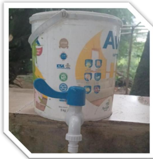
Gambar 2 Alat pengolahan air dari ember cat
