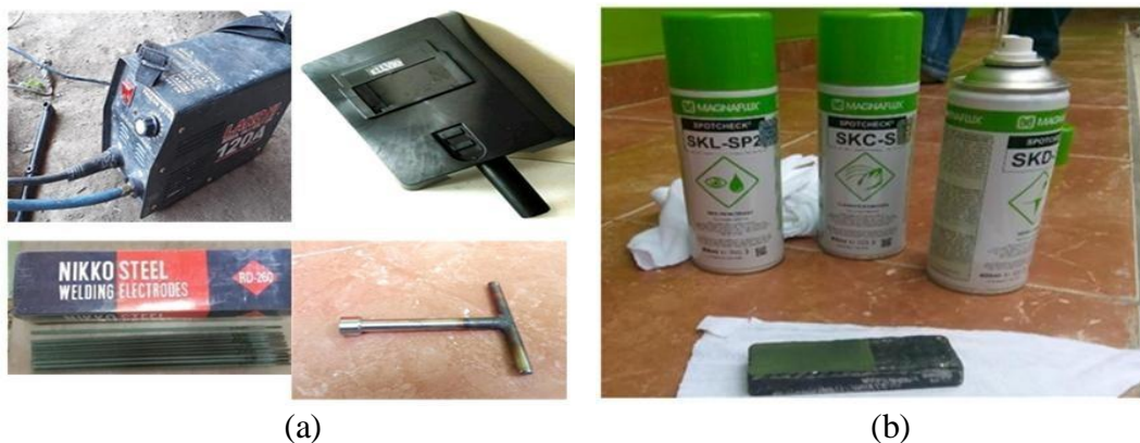
Gambar 1. (a). Alat peraga untuk proses pengelasan dan (b). Liquid Penetrant Testing
