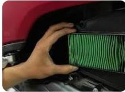
Caranya, filter udara dicuci menggunakan air detergen (tidak boleh menggunakan cairan yang mudah terbakar) atau cairan pembersih lalu kemudian diperas. Selanjutnya, keringkan dengan cara disemprot menggunakan alat penyemprot udara bertekanan. Kemudian lumasi filter udara menggunakan oli.
