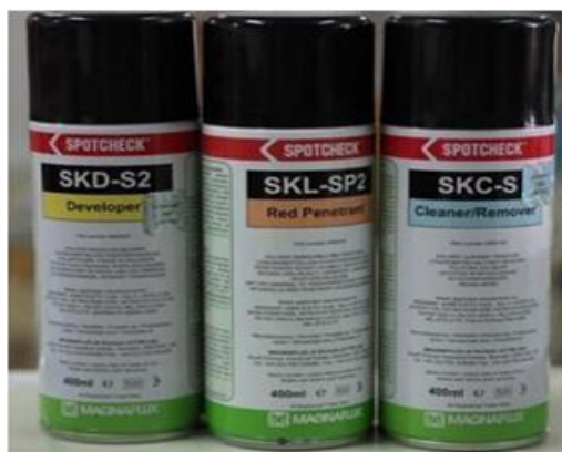
Gambar 2. Bentuk fisik liquid penetrant testing, sebagai salah satu metode pengujian kualitas hasil pengelasan
