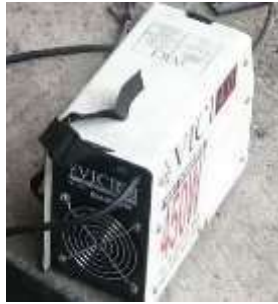
Gambar 1. Mesin Las SMAW
