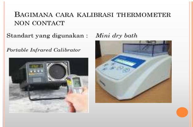
Gambar 4. Contoh Kalibrasi Thermometer
