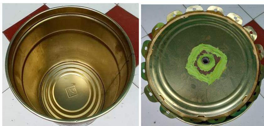
Gambar 1. Bagian dalam dan tutup alat pengarangan
