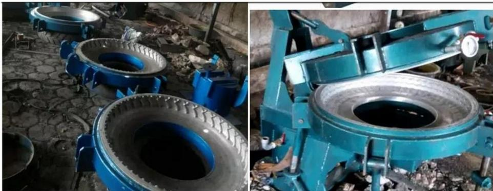
Gambar 3. Mesin cetak press vulkanisir ban sepeda motor
