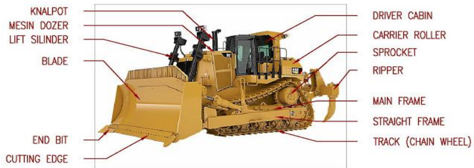
Gambar 2.1. Bagian-bagian utama bulldozer
