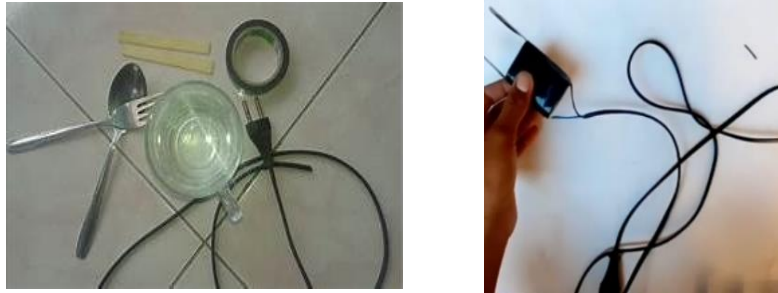
Gambar3, Bahan Utama dan rangkaian Pemanas Air Ohmik Sederhana
