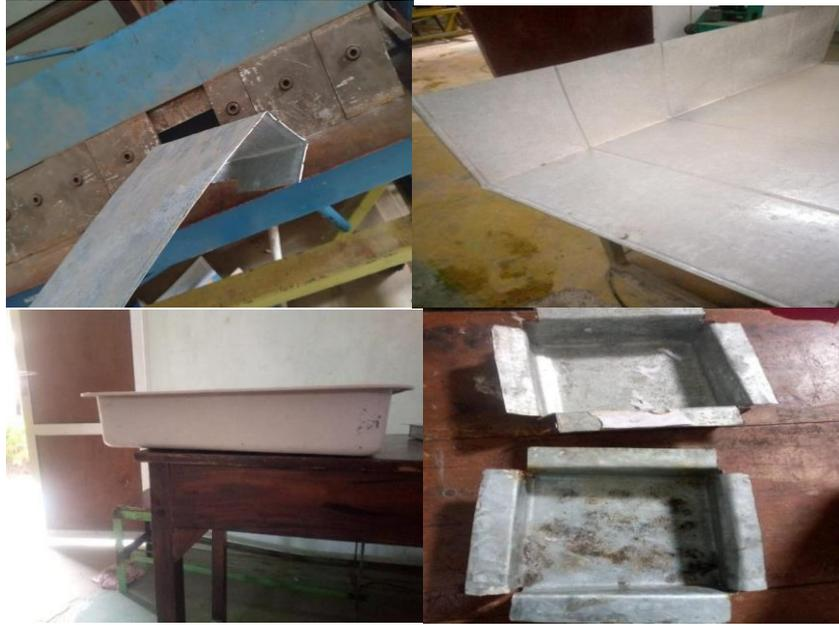
Gambar 5. Foto produk sederhana hasil dari praktik penekukan/bending
