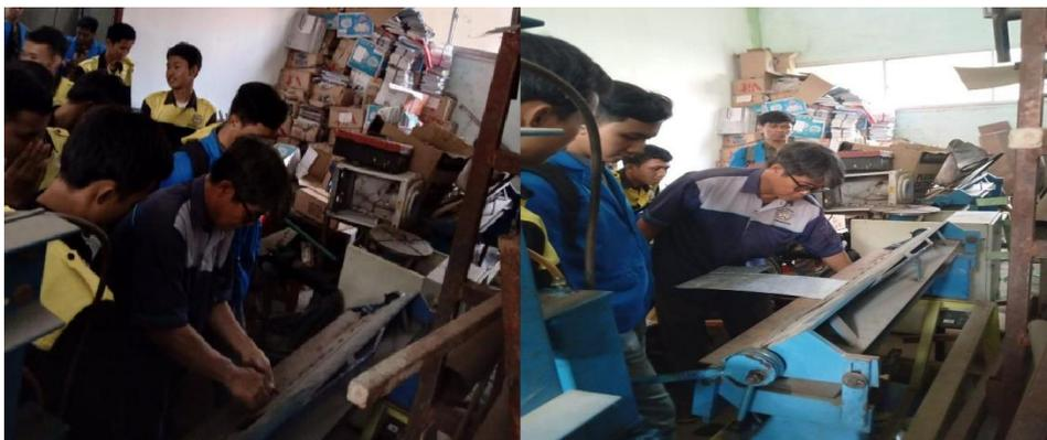
Gambar 4. Photo pelaksanaan praktik penekukan plat menggunakan mesin bending
