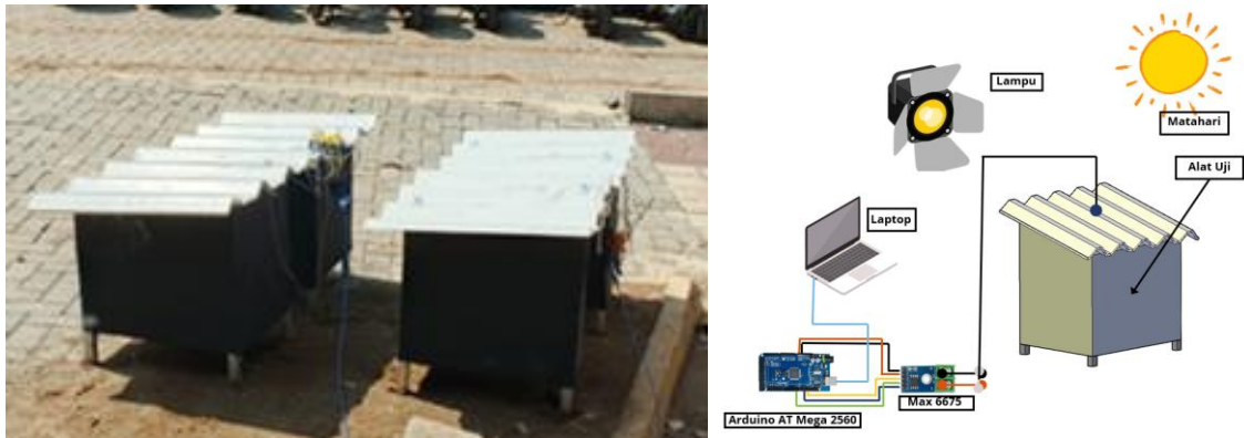
Gambar 3. Prototype Alat yang Diuji dengan Menggunakan Sistem Akuisisi Data Instrumentasi Pengukuran Berbasis Arduino
