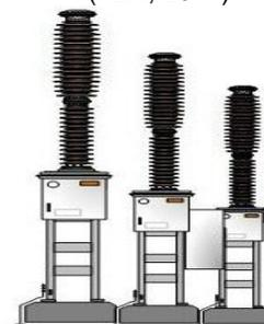
Gambar 2. Pemutus tenaga bertegangan 150 KV (PLN, 2014)
