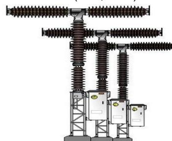
Gambar 3. Pemutus tenaga bertegangan 500 KV (PLN, 2014)
