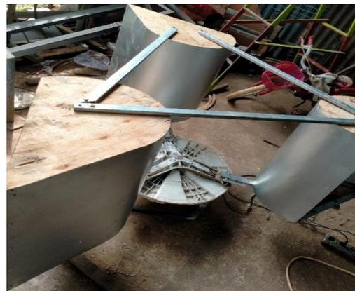
Gambar 4. Konstruksi turbin angin
