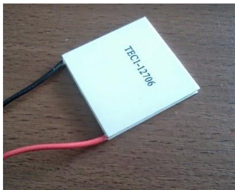
Gambar 1. Modul Termoelektrik (Kurniawan, 2019)
