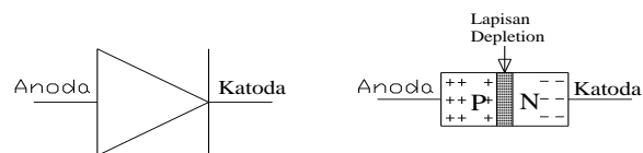
Gambar 2.4. Simbol dioda dan bagian dalam
