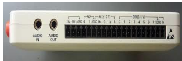
Gambar 2.8. Analog input/output dan Digital input/output.
