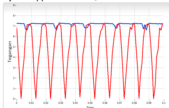
Gambar 4.1. Grafik hasil tegangan 2 dioda dengan tapis.
