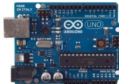
Gambar 1 Papan Mikrokontroler Arduino Uno
