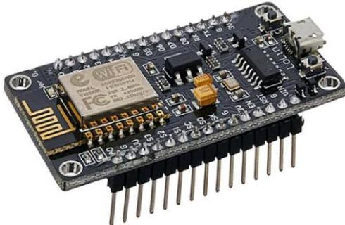
Gambar 2. NodeMCU ESP 8266
