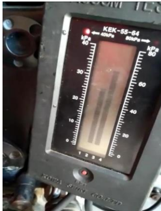
Gambar 11. Kondisi tekanan karburator tidak sinkron
