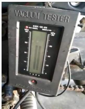
Gambar 12. Kondisi karburator sinkron
