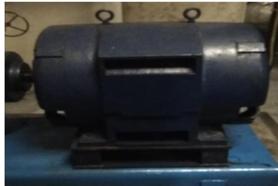
Gambar 1. Motor induksi tiga fasa
