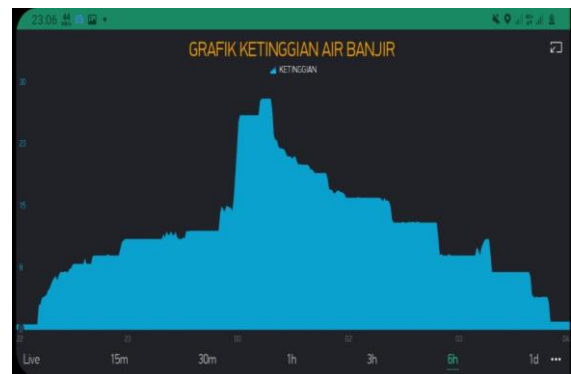
Gambar 17. Grafik Monitoring Ketinggian Air Saat Terjadi Banjir Pada Aplikasi Blynk
