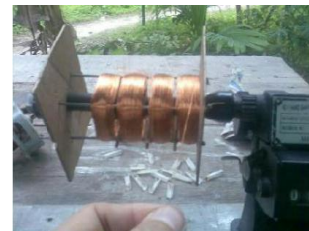
Gambar 1. Proses menggulung kumparan dengan alat mal.
