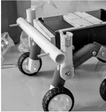
Gambar 9. Tampak batang diferensial pada purwarupa robot
