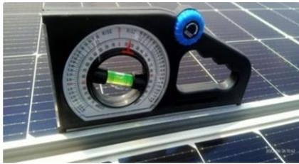
**Gambar 3.** Pengukuran sudut kemiringan PLTS tahap 2
