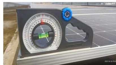
Gambar 2. Pengukuran sudut kemiringan PLTS tahap 1
