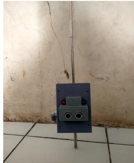
Gambar 9. Hasil perakitan tongkat pintar
