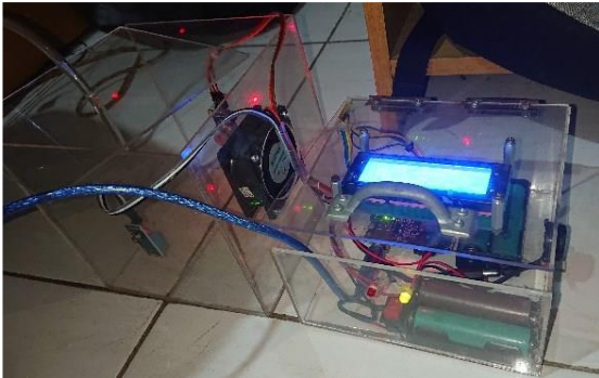
Gambar 9. Prototipe pengujian kebocoran gas LPG dengan Arduino.
