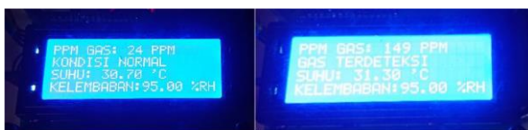
Gambar 10 (a) Tampilan Indikator konsentrasi gas LPG pada kondisi (a) normal; (b) meningkat di atas ambang batas
