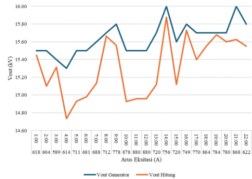
Gambar 1. Hubungan arus eksitasi terhadap tegangan keluaran
