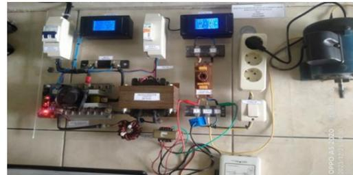
**Gambar 7.** Pengujian dengan beban induktif
