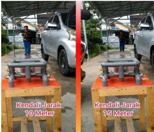
Gambar 15. Menguji jarak koneksi *remote* dengan robot 10 m – 15 m
