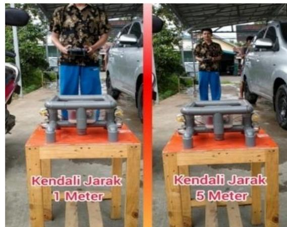
Gambar 14. Menguji jarak koneksi *remote* dengan robot 1 m – 5 m
