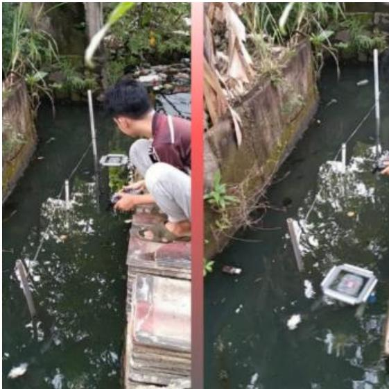
**Gambar 18.** Menguji kecepatan pergerakan mundur robot
