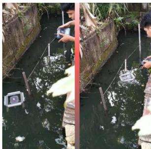
Gambar 11. Menguji sensitivitas pergerakan belok kiri dan kanan robot
