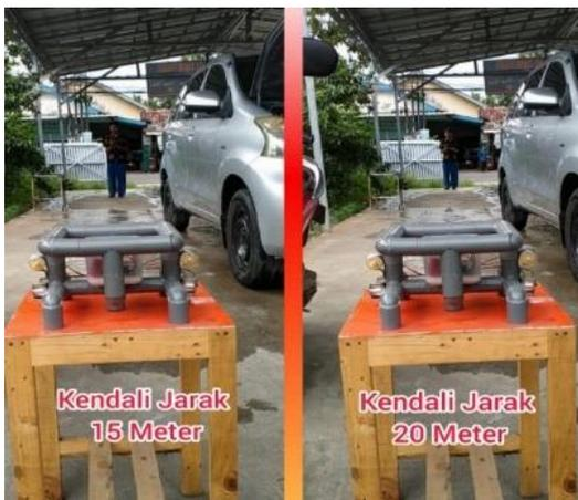
Gambar 16. Menguji jarak koneksi *remote* dengan robot 15 m – 20 m
