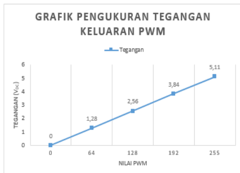
Gambar 10. Grafik Pengukuran tegangan Keluaran PWM
