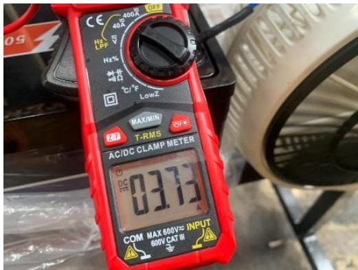
Gambar 7. Pengukuran Arus Pada Baterai Lithium
