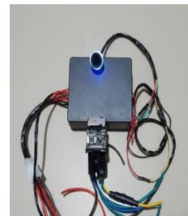
Gambar 1 Hasil Perakitan Alat system keamanan sepeda motor
