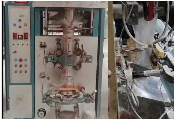
Gambar 4. Implementasi Thermocouple Tipe-K pada Sistem Pengemasan Otomatis
