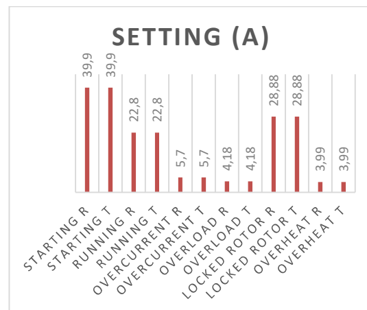
Gambar 2. Grafik Arus Setting pada Motor 6 kV CCCW PLTU Banten 1 Suralaya
