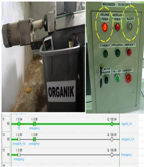
Gambar 18. Pengujian Penampungan Sampah Organik Penuh
