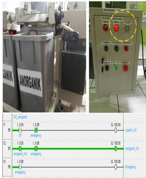
Gambar 17. Pengujian Penampungan Sampah Anorganik Penuh
