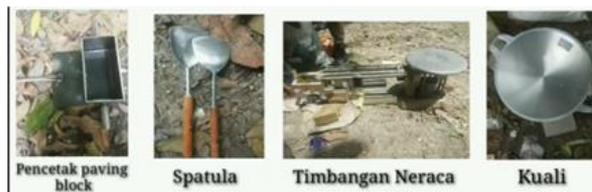
Gambar 2. Alat yang digunakan dalam pembuatan paving blok
