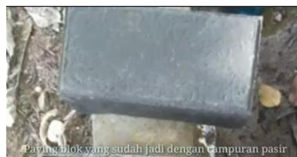
Gambar 5. Hasil Cetakan paving blok model segiempat
