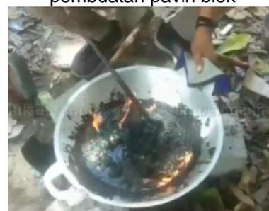
Gambar 3. Demo pembuatan paving blok dari limbah plastik
