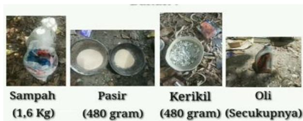
Gambar 1. Bahan pembuatan Paving Blok
