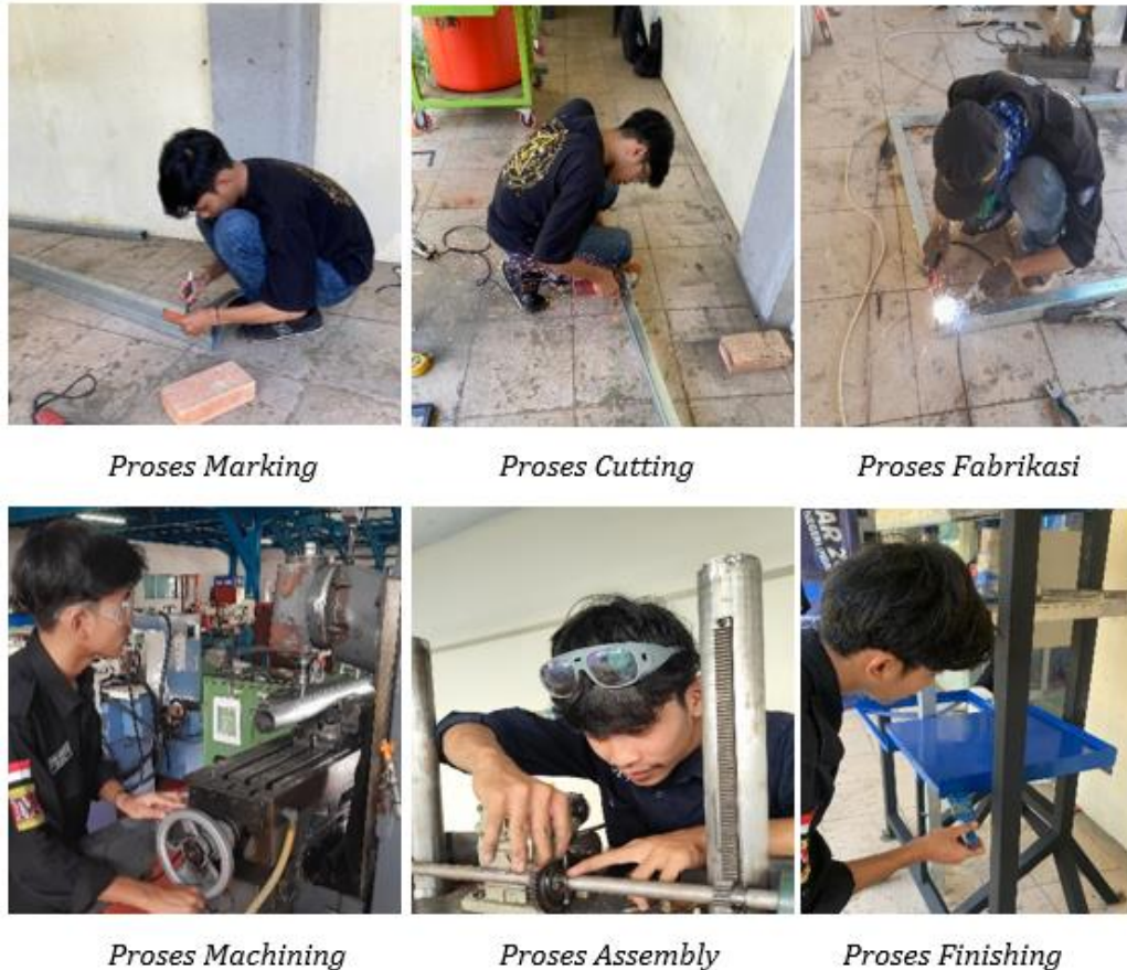
Gambar 3. Proses Pembuatan Mesin Pencetak Tahu Model 2 in 1
