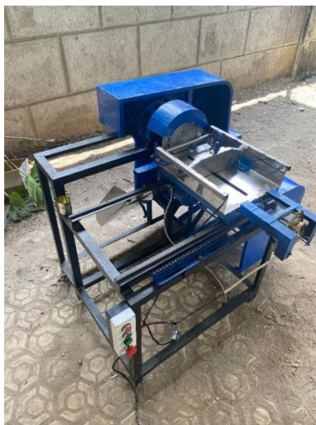
Gambar 5. Hasil Fabrikasi Mesin Pemotong Adonan Kerupuk Bonggol Pisang Semi Otomatis
