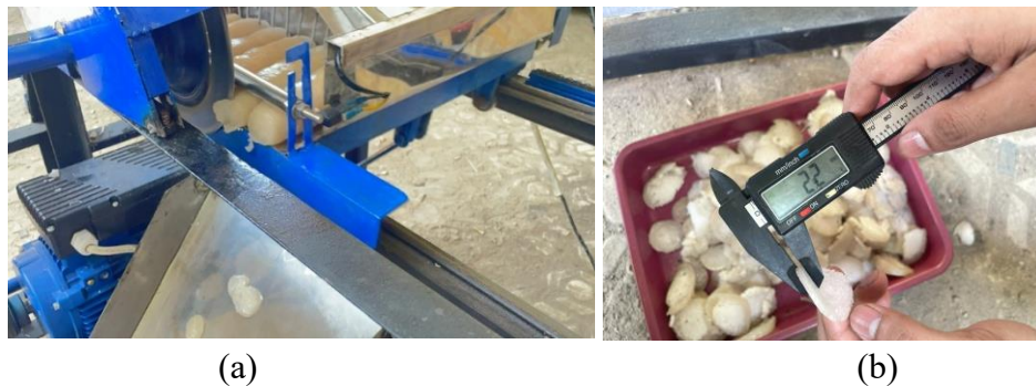
Gambar 6. (a) Proses Pengujian Pemotongan Adonan Kerupuk (b) Pengukuran Ketebalan Hasil Potong Adonan Kerupuk
