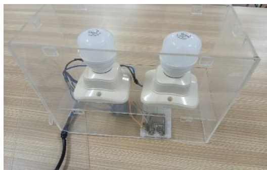
Gambar 2 Desain Sistem Kontrol Peralatan Listrik Jarak Jauh Menggunakan Bluetooth
