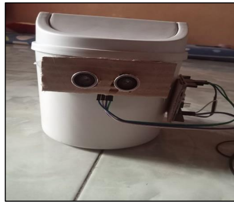
Gambar 2. Prototipe Tempat sampah otomatis Sumber : Dokumentasi Pribadi(2025)
