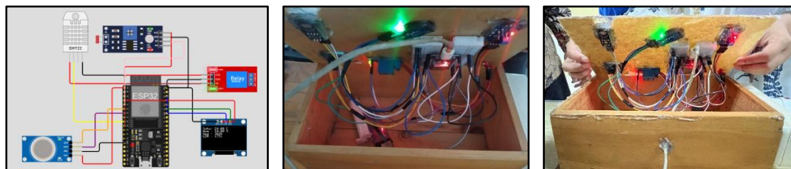
Gambar 5. Simulasi Rangkaian dan Prototipe Hardware yang berhasil dibuat
