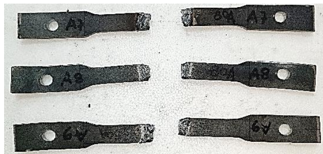
Gambar 6. Hasil Spesimen Uji Tarik dengan pengelasan SMAW arus 80 amper
