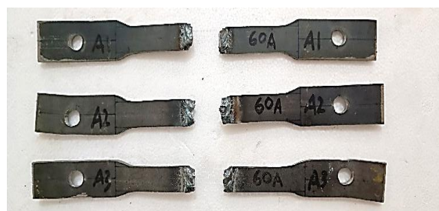
Gambar 4. Hasil Spesimen Uji Tarik dengan pengelasan SMAW arus 60 amper
