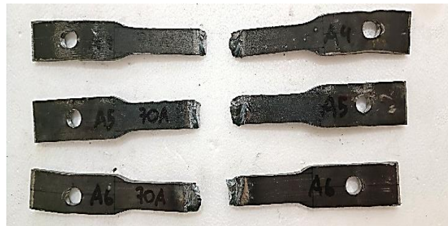
Gambar 5. Hasil Spesimen Uji Tarik dengan pengelasan SMAW arus 70 amper
